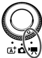
Для выполнения видеосъемки переведите диск установки режима в положение <M>. Используется тип видеоизображений MOV.
