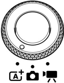
Используйте для фотосъемки <A+> или <📷>, а для видеосъемки используйте <📹>. <A+> Интеллектуальный сценарный режим позволяет просто нажать кнопку затвора для фотосъемки, при этом камера автоматически выполнит все настройки с учетом объекта съемки или сцены. При использовании <📷> для фотосъемки можно выбрать режимы творческой зоны или базовой зоны.
